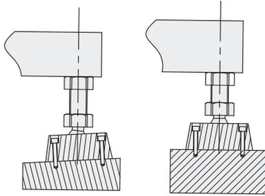
可根据安装现场情况，加工安装孔，利用螺钉固定脚杯
