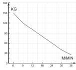
! 选型负载请参照阻停能力曲线图, 表中条件在工作压力0.5Mpa下测试所得。
