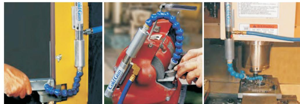
快速降温至可手握加工且防止产品因高温产生变色    冷气流防止工具在钢化过程中热裂    使硬质合金刀具延长 50% 以上寿命
