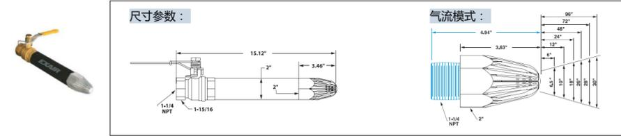
型号：AGSF-SB17-ZAA 超级冲击安全喷枪
