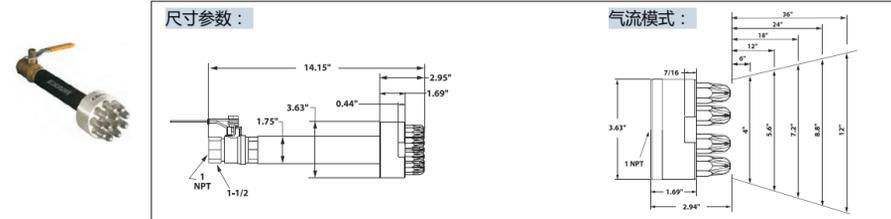
型号：AGSF-SB14-ZAA 超级强气流高压喷枪
