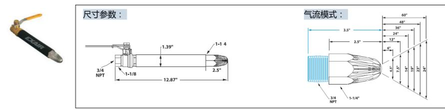
型号：AGSF-SB15-ZAA 超级冲击安全喷枪
