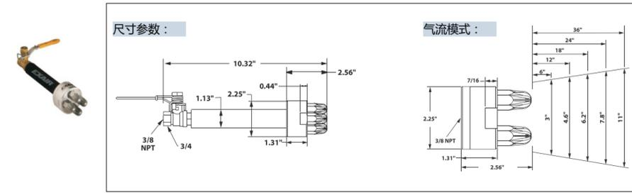
型号：AGSF-SB13-7-ZAA 超级强气流高压喷枪
